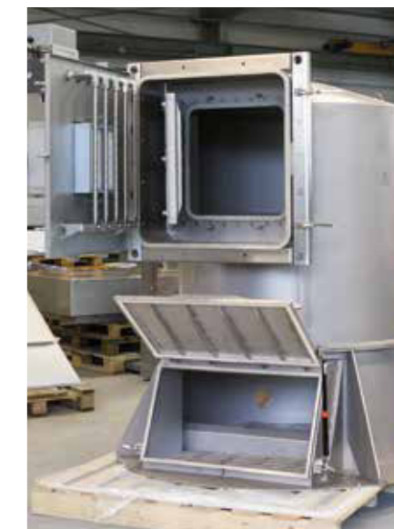
Es ist gelungen, die Filterschlitzplatte „schwenkbar“ zu gestalten. Hierdurch erhält man nach dem Öffnen ein großes Mannloch. Damit wird der Filterraum einfacher zugänglich und reinigbar.
